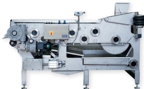
Измельченная масса подается из мельницы в дозатор пресса, откуда равномерно поступает на ленту пресса. Полученная масса проходит через основную стадию отжима, где извлекается 70% сока. Далее спрессованная масса проходит через три последовательно установленных дополнительных прижимных ролика, что позволяет извлечь максимум сока.
